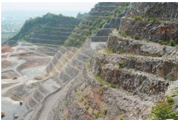
図4. 金生山の石灰石鉱山における大規模ベンチ型切り羽。
