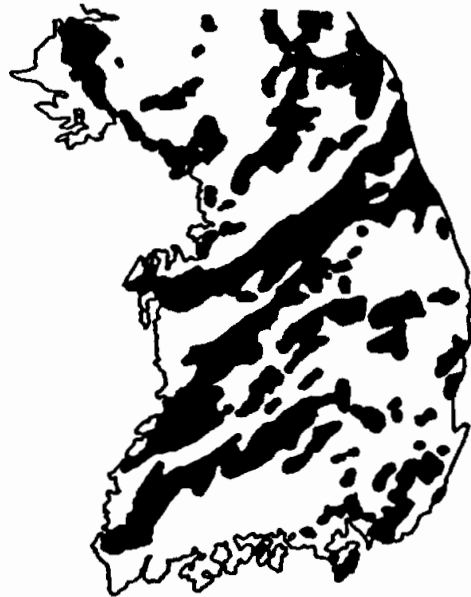
図1 韓国における花崗岩（類）の分布 Fig 1 Distribution of Granite in R.O.K.
