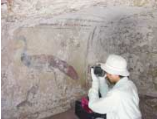
環境測定 (左：壁面の表面温度測定 右：二酸化炭素濃度測定)
