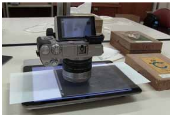
写真3 エクステンション・チューブによる拡大写真撮影
