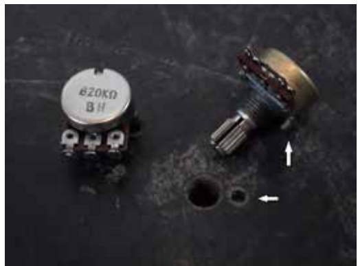
写真12 板の開口部に収まる可変抵抗器
