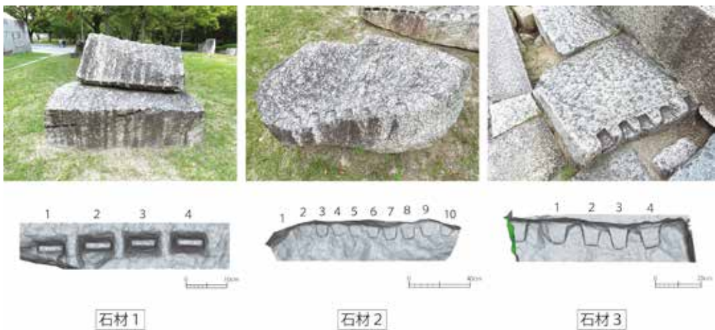
図5 誤差値比較資料の石材と矢穴列の3Dモデル
